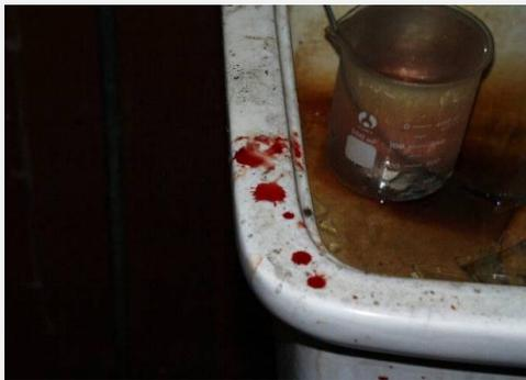
2006年1月21日，北京大学多氮化合物爆炸事故，实验人员将多次合成所得的产物（多氮化合物）装瓶保存，在装瓶过程中有一小块产物粘在瓶口，当事人用不锈钢匙拨下粘在瓶口的产物时多氮化合物发生爆炸，玻璃碎片四处飞溅，将当事人一眼睛的角膜、脸、腹部和手割伤，耳膜受到巨大的爆炸声震伤。
